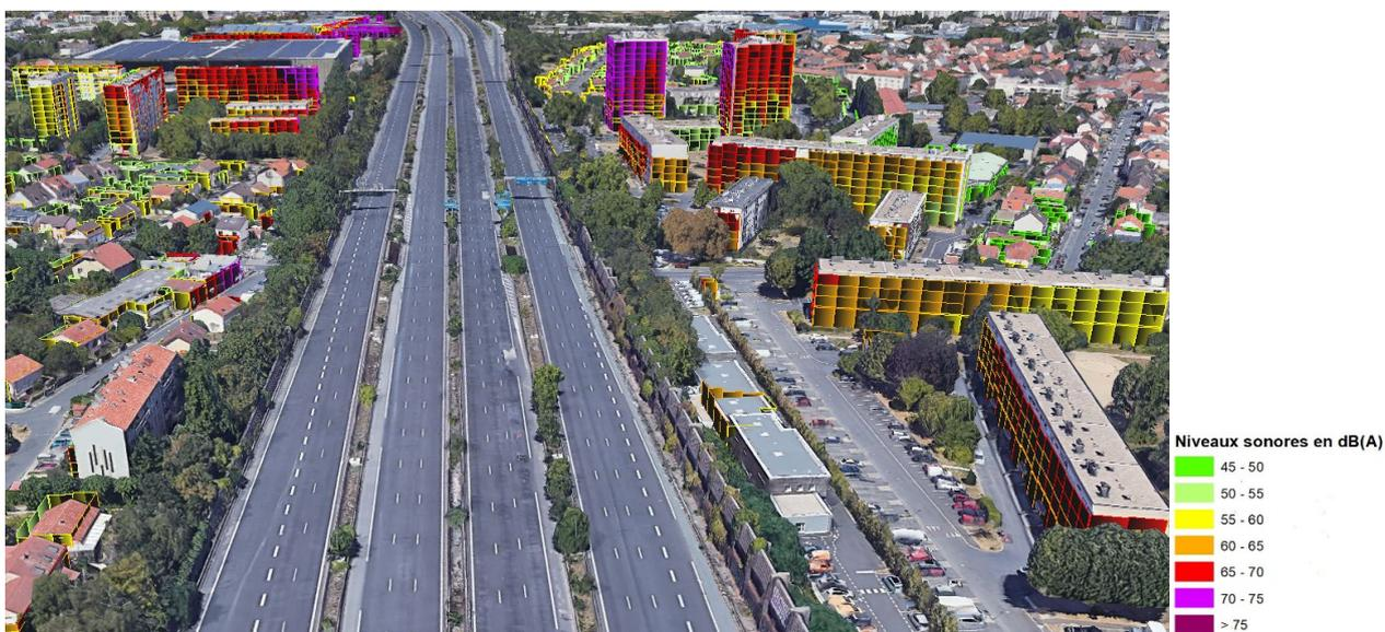
Figure 4 : Cartographie du bruit routier (selon l'indicateur  $L_{den}$ ) générée par l'autoroute A6 en façade des bâtiments de l'Haj-les-Roses **un an après** la pose du revêtement antibruit
