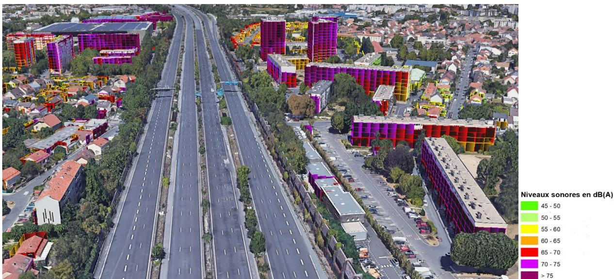
Figure 3 : Cartographie du niveau sonore (selon l'indicateur  $L_{den}$ ) générée par l'autoroute A6 en façade des bâtiments de l'Haj-les-Roses **avant** la pose du revêtement antibruit
